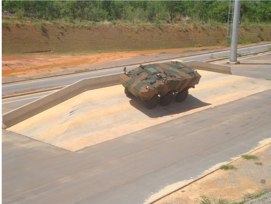
Teste de rampa lateral 30%
