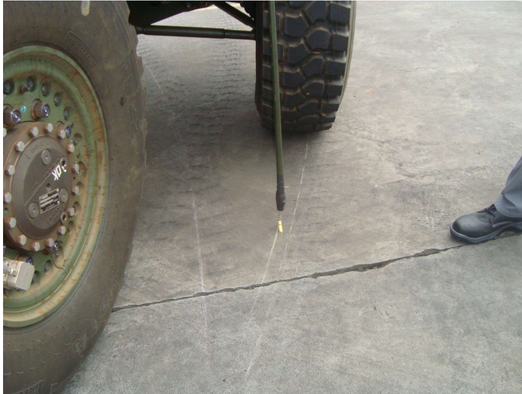
Verificação raio de giro
